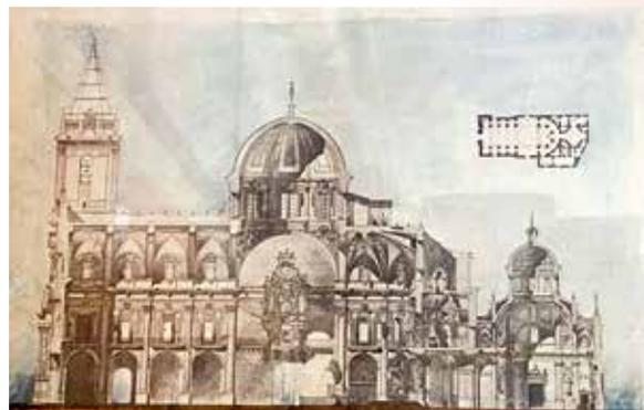
Foto nº 12. Dibujo transversal de la Basílica de Santa María de Elche. A la derecha de la cúpula, se observa la caseta o "barraca" que protegía y guardaba el torno.
