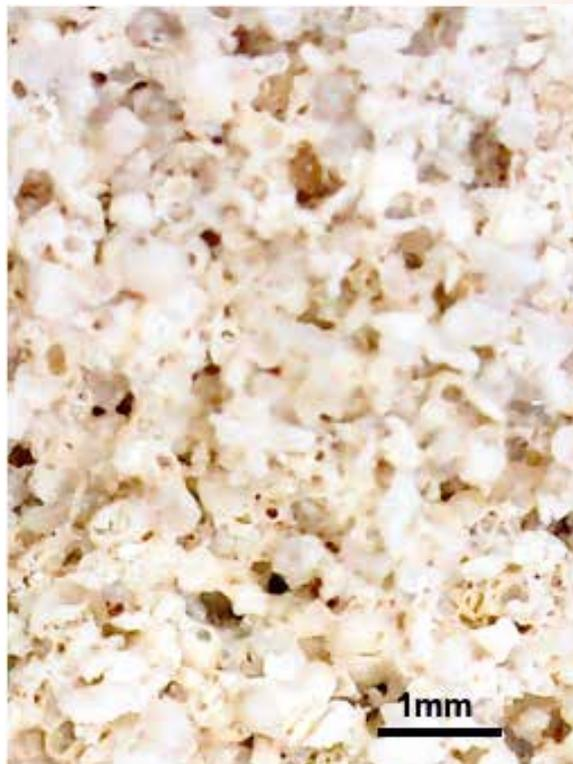
Figura 11: Observación con microscopio portátil de la piedra presente en contrafuerte de la Basílica zona norte.
