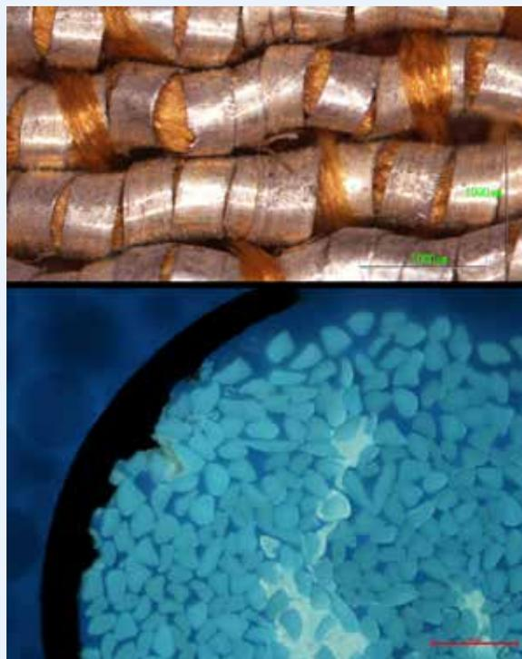
Figura 23. Análisis de la sección transversal con microscopía óptica con luz UV del hilo metálico entorchado rizado del tejido *Cáliz Corona*, donde se ha identificado el empleo de seda en el hilo del alma. Se observan las características morfológicas propias de esta fibra.
