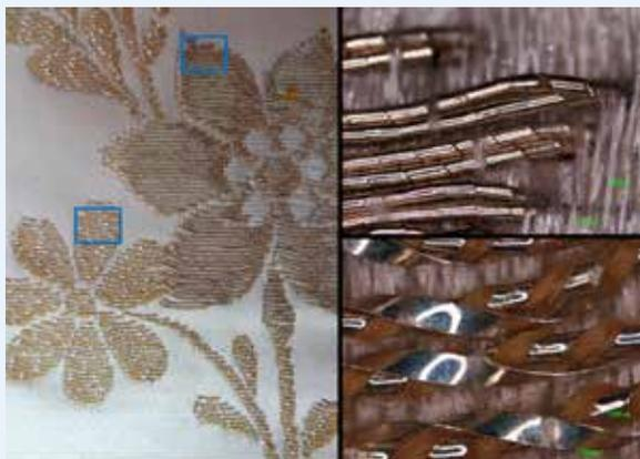
Figura 25. Imágenes con microscopía estereoscópica de los tres tipos de tramas metálicas espolinadas, utilizadas para realizar los efectos de la decoración en el tejido *Herradura*.
