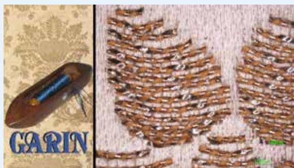
Figura 19. Imagen de un espolín, término como se denomina a la pequeña lanzadera empleada para tejer espolines (Fuente: Empresa Garín. <http://www.garin1820.com>). Detalle de la técnica de espolinado del tejido diseño *Herradura*.
